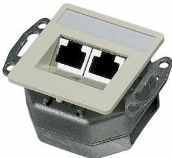
Die Wanddosen sehen etwa so aus wie in der obigen Abbildung. Jeder Anschluß hat eine eindeutige Nummer. Das hier angeschlossene Kabel geht von der Buchse aus durch das Gebäude und endet an einem der Anschlüsse im Patchfeld. Dieser Port des Patchfeldes hat dieselbe Nummer wie der Port in der Wandsteckdose.
