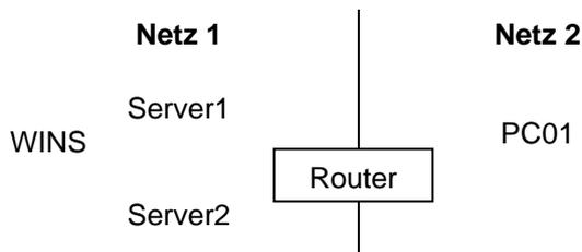
Sie haben neben dem bisherigen Netz (Netz1) ein neues Subnetz aufgebaut (Netz2) und dieses mit einem Router angebunden. Sie geben PC01 eine im Netz2 gültige IP – Adresse.
