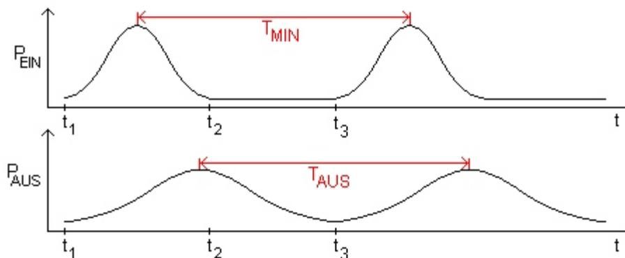
Im Bild dargestellt ist das Eingangs- und das Ausgangssignal eines Lichtwellenleiters bei der maximalen Einkoppelfrequenz (die Frequenz, bei der die Ausgangsimpulse gerade noch nicht ineinanderfließen).
