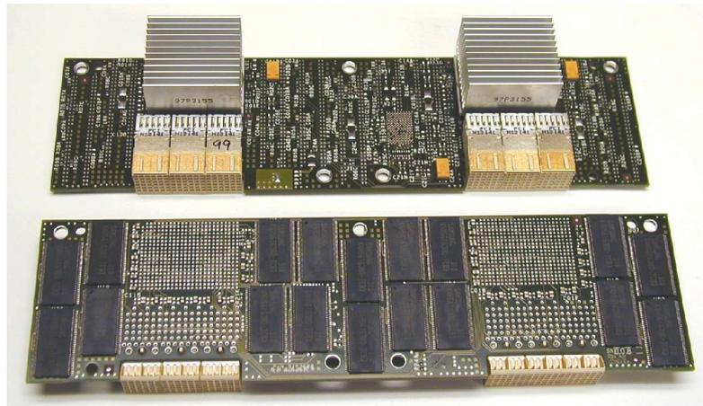
*Abbildung 4: ein Chip mit zwei Prozessoren des BlueGene/L*
